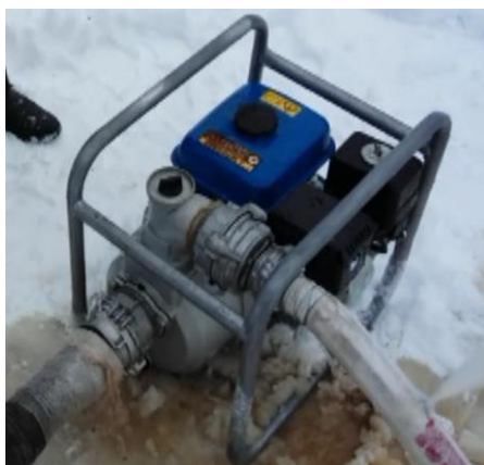
Забор воды пожарной мотопомпой
