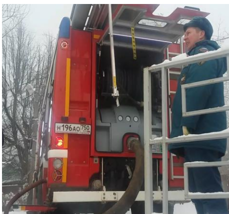
Забор воды пожарной автоцистерной
