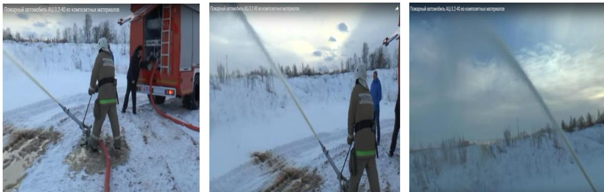
**Автоцистерна** оборудована сигнально-громкоговорящей установкой. Основное функциональное назначение автоцистерны заключается в том, чтобы с помощью имеющегося оборудования и принадлежностей подавать при пожаре воду или воздушно-механическую пену до полной ликвидации возгорания.
