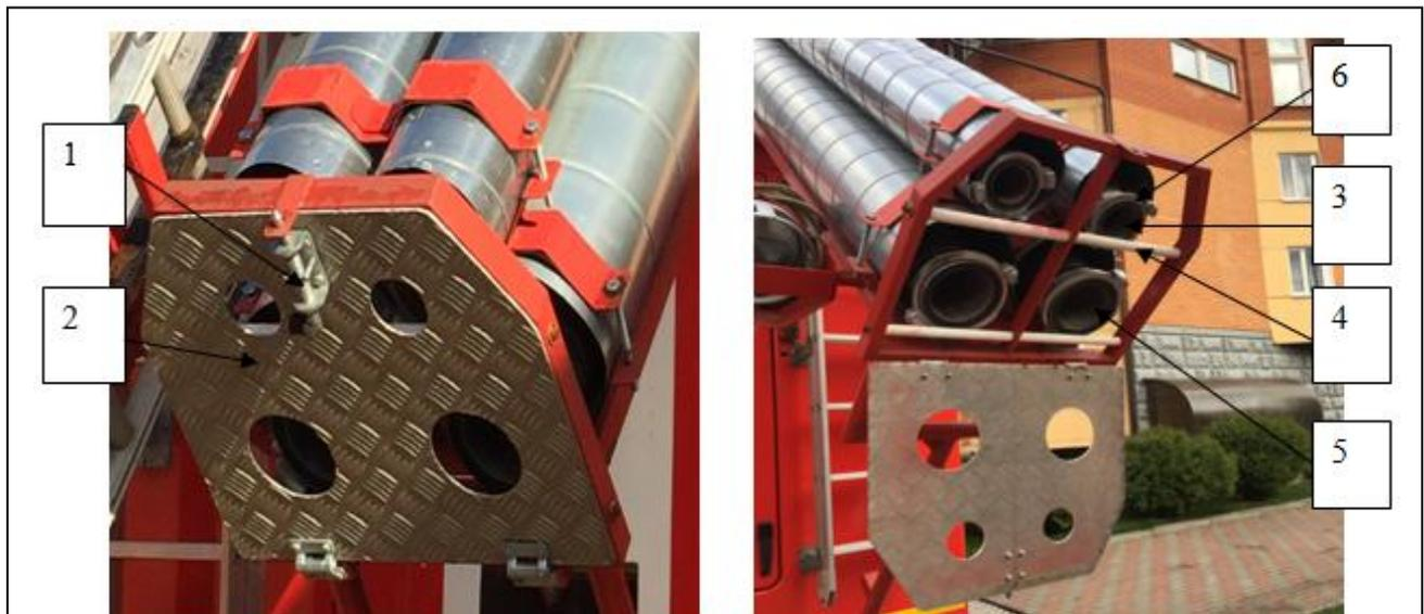
Рисунок 3 Механизмы открывания пеналов
