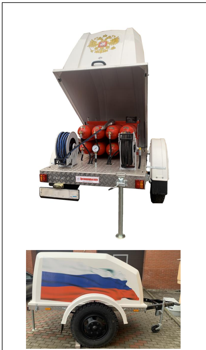
Рисунок 1. Прицеп газового тушения ПГТУ 280-(755) ОУ-400(02).ПС
